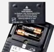
Getrenntes Batterie- und Sicherungsfach
