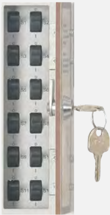
Fehlersimulator mit 12 Fehlermöglichkeiten über Schalter
