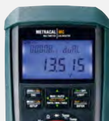
Displaybeleuchtung und Mehrfachdisplay z.B. Funktionen und Ausgabewert oder Mess- und Simulationswert etc.
