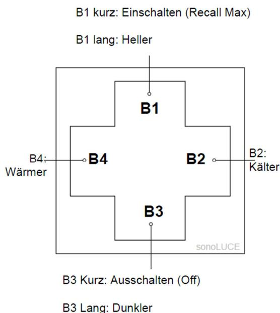
Einstellmöglichkeiten für das Schaltverhalten eines Tasters:
